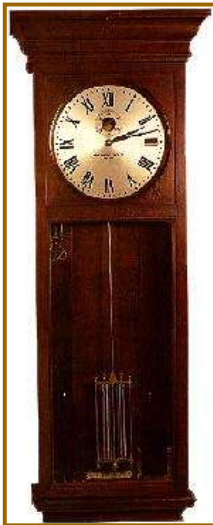
Reloj patrón de señal horaria Self Clock Co. of New York, Estados Unidos 1926
