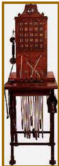
Centralita: modelo pupitre de batería local L. M. Ericsson, Suecia 1884
