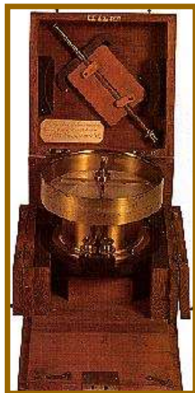
Galvanómetro Elliot Bros. of London, Inglaterra 1890
